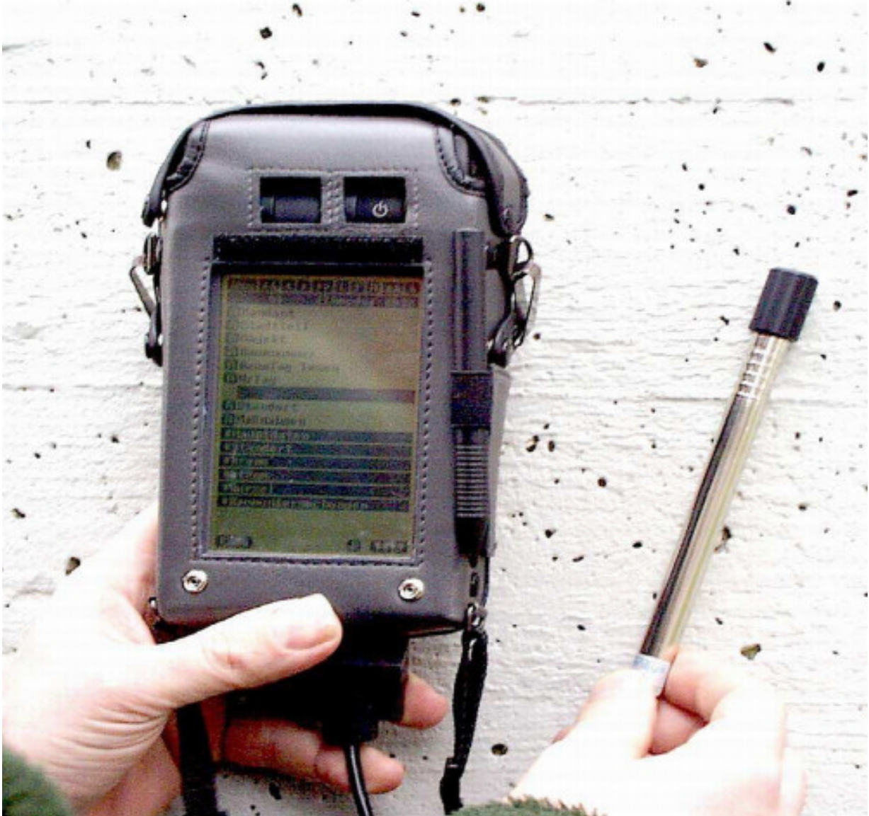
Abb. 3 ) Handgeräte und Baumtags haben dazu beigetragen, die Datenerfassung und Datenpflege vor Ort schneller und effektiver als bisher durchführen zu können. Außerdem wird durch die Mikrochipkodierung zur Identifizierung der Bäume die Gefahr von Fehleingaben deutlich verringert.
